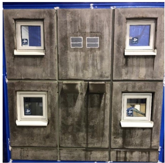
Figur 6. Objekt 1, a) utsida (fasad) av betongsandwichvägg monterad i regnkammare, b) objekt 2, utsida (fasad) betongsandwichvägg direkt efter regnexponering i regnkammare.
