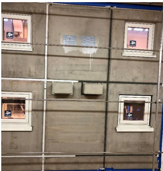
Figur 6. Objekt 1, a) utsida (fasad) av betongsandwichvägg monterad i regnkammare, b) objekt 2, utsida (fasad) betongsandwichvägg direkt efter regnexponering i regnkammare.
