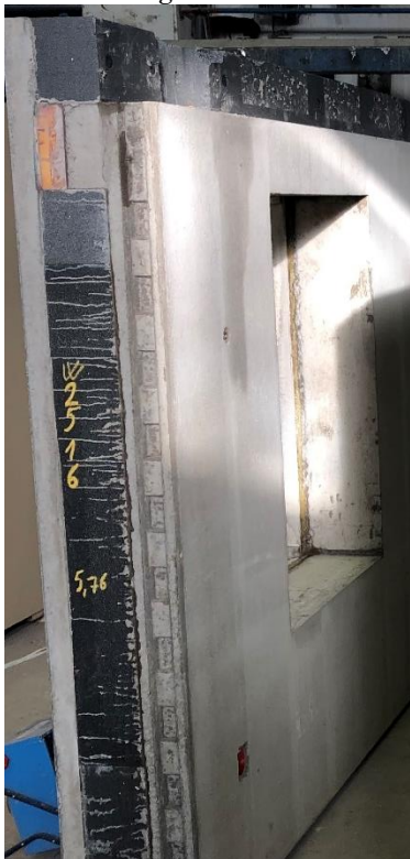
Bild 2.11. Lagring av betongsandwichelement i fabrik
